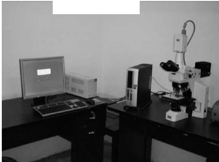
الشكل (3) المجهر الضوئي، نوع (Nikon)، المزود بكاميرا رقمية، ونظام تحليل الصور (Lucia Image, Version 4.81) المستخدم في الفحوصات الميتالورجية
